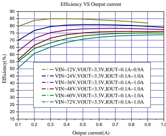
Figure15. VIN=8V~80V, VOUT=3.3V
