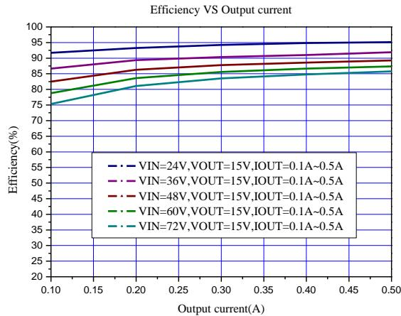
Figure13. VIN=20V~80V, VOUT=15V
