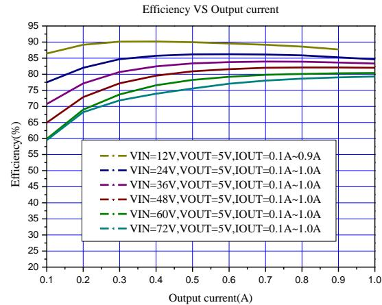
Figure14. VIN=10V~80V, VOUT=5V
